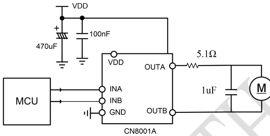
请确保输入信号 INA 和 INB 引脚在上电和掉电期间保持低电平。
