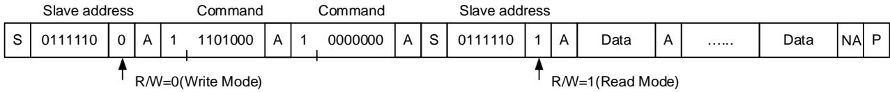
在读取模式下，可以通过 SDA 线从 DDRAM 中读取显示数据。首先执行“写操作”，以确定要访问的 DDRAM 地址。然后，发送“启动条件”以及从机地址“01111101”（读模式），之后 SDA 线便会连续输出显示数据。如果在读取 DDRAM 之前没有指定 DDRAM 地址，则读取模式期间的输出将来自当前 DDRAM 地址。
